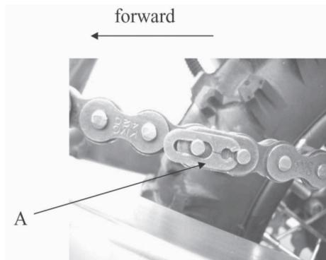
1. Когда цепь особенно сильно загрязнилась из-за грязи или песка, ее нужно снять и почистить.
