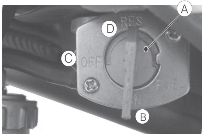
А – заслонка топливного бака
