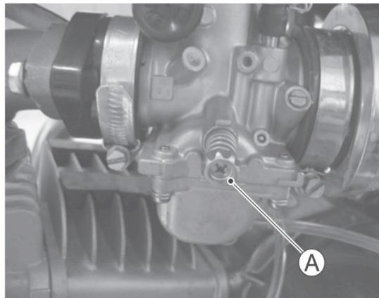
A – регулировочный винт
