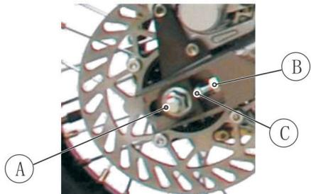
А – гайка оси
